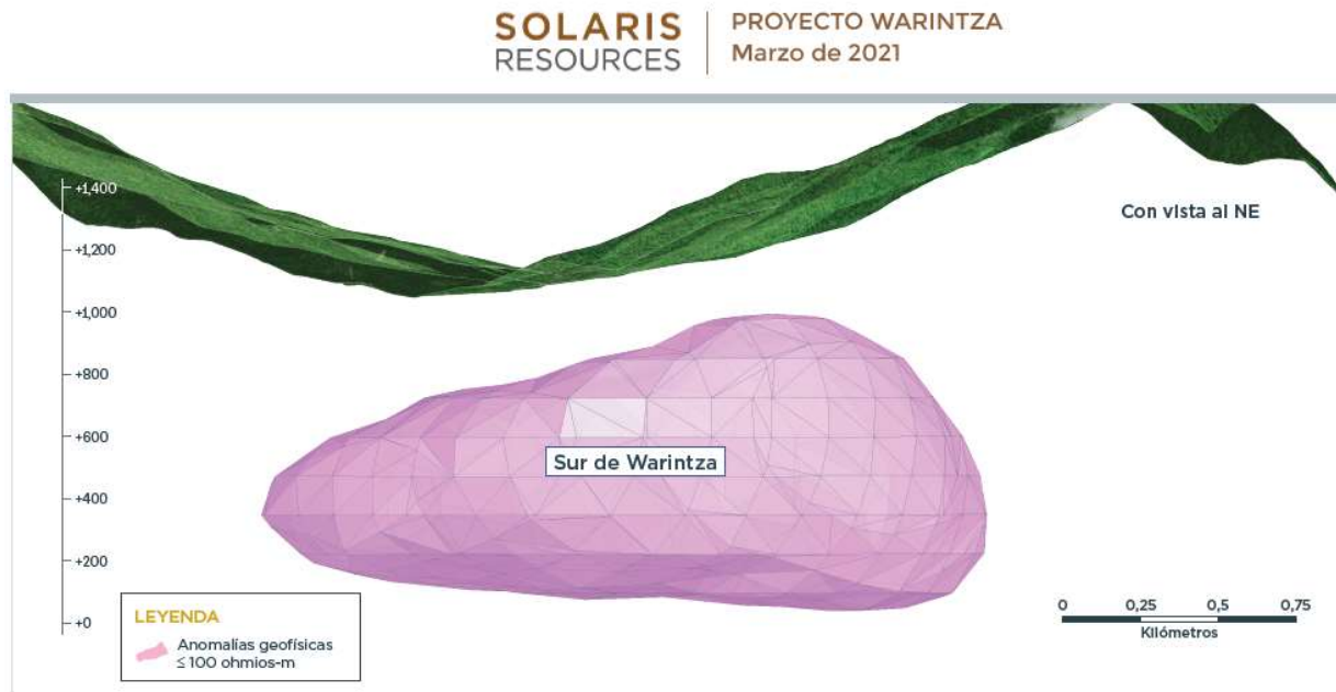
Figura 2: Sección larga de geofísica 3D que mira hacia el noreste en el sur de Warintza
